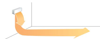
Заслонка закручивает поток воздуха вниз, обеспечивая более эффективный обогрев
